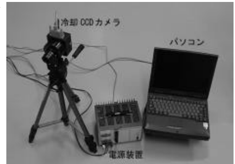
撮影に使用した機器類
